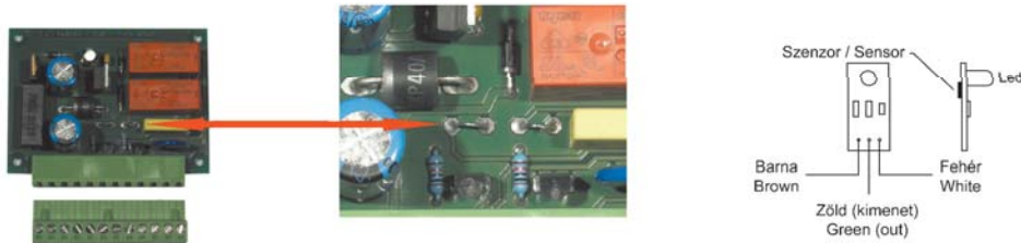
Vezérlőkártya felépítése Electronic board design
